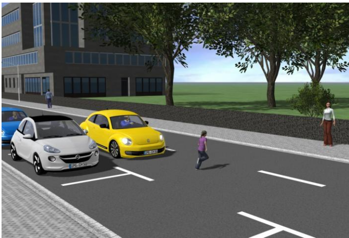
Abbildung 1: Euro NCAP-konformes Testszenario Notbremsassistent (AEB City) in CarMaker 5.0
